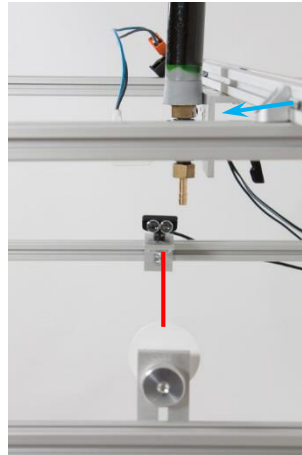
Abbildung 11: Tropfenspender rechts vom Lichtstrahl
