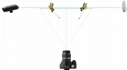
Schéma 15: mise au point parallèle au faisceau
